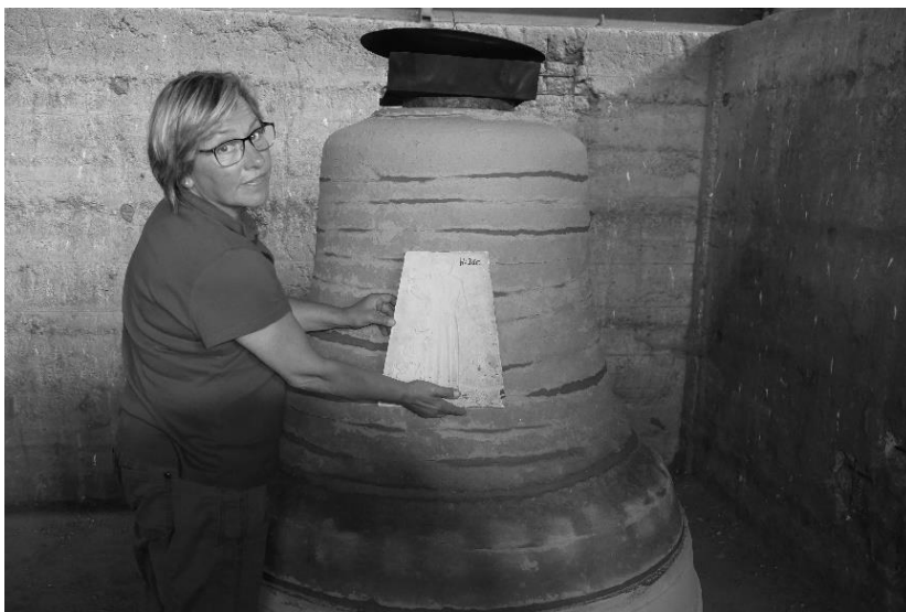
Glockengießerin Cornelia Mark-Maas aus Brockscheid vor der sog. Manderscheider „Falschen Glocke“, die eine Vorstufe ist für die später zu gießende Bronzeglocke
